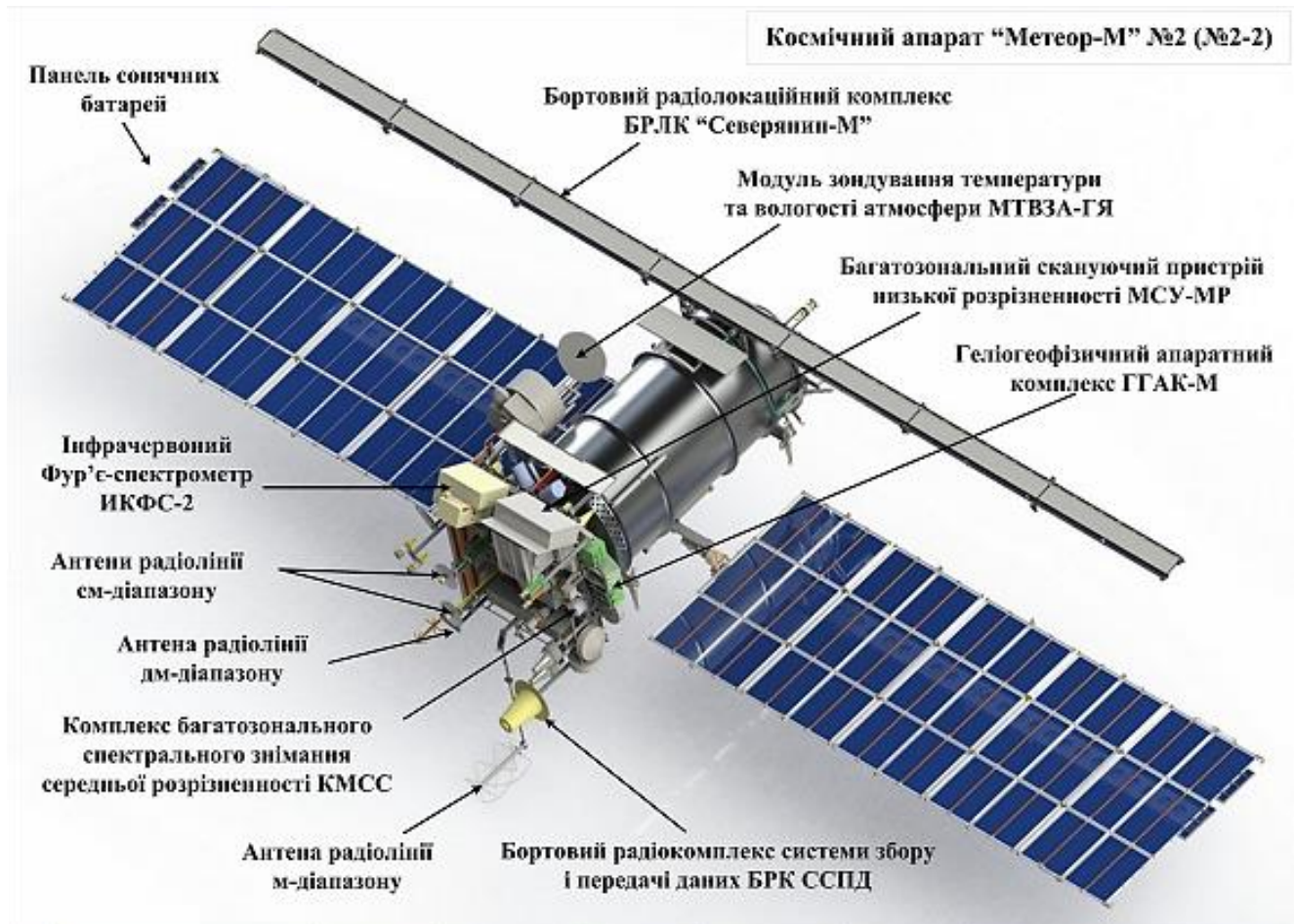
Рис. 2.29. Загальний вигляд і основні бортові модулі КА “Метеор-М”
