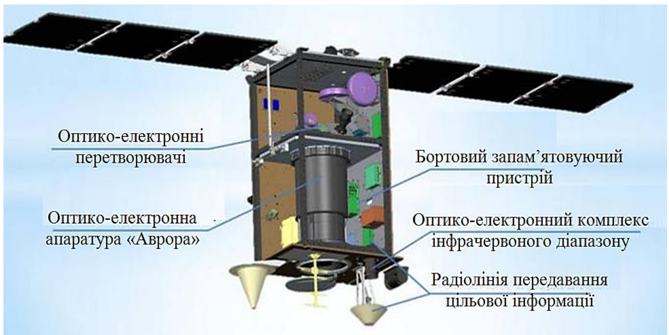
Рис. 2.15. Загальний вигляд і компоновання КА “Аіст-2Д”
